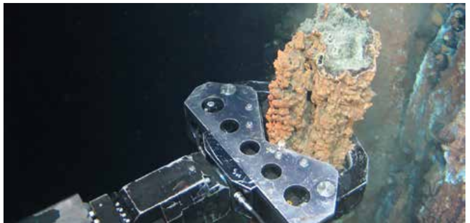
机械手臂在深海中获取铜量丰富的热泉烟卤样本。
