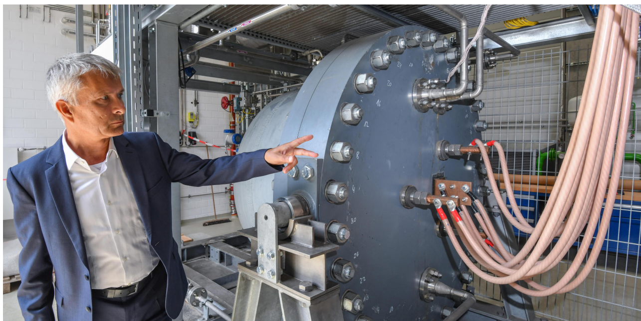
德国勃兰登堡技术大学氢气研究中心，用于生产氢气的碱性压力电解器。
