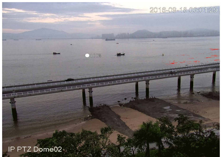
系统投入运营前几个月，厦门附近九龙江边一台塑料污染监测摄像机拍摄的图像。红色区域是计算机识别的漂浮垃圾。(图片来源：张彩云)
