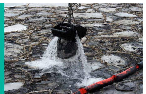
一根用来限制重油在海面上扩散的红色浮杆。在冰层覆盖的地区进行清洁作业特别困难。图片来源: © Jon Terje Hellgren Hansen / Greenpeace
