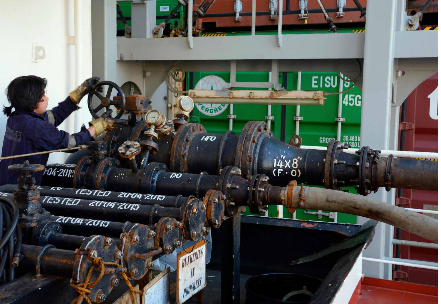
希腊比雷埃夫斯港 (Piraeus port), 货船“科塔桑托斯号” (Kota Santos) 正在加注重油。清洁北极联盟表示, 改用馏分燃料并安装污染过滤器可以将船舶的排放量减少90%。图片来源: Joachim Affeldt / Alamy
